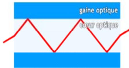
Figure 1.6: Guidage de la lumière dans le coeur de la fibre
